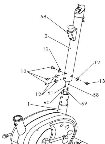
Krok 2: spojte cívku (60) k indukční šňůře (61), poté spojte kabel (59) se zátěž. kolem (58), upevněte úvodní část trubky (2) k hlavní konstrukci (1), dotáhněte pomocí šestihranného hlavového šroubu (13) a malým klenutým těsněním (12).
