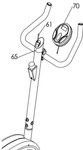
Krok 4: spojte drát elektrického měřiče (70) k spojení cívky (61), poté vložte elektrický měřič do držiče elektrického měřiče (65).
