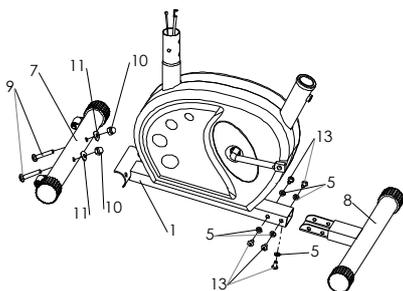
Krok 1: spojte přední a zadní spodní tyč (7, 8) na hlavní konstrukci (1) pomocí šroubu se čtvercovým hrdlem (9), klenuté podložky (11) a zavřené matice (10).
