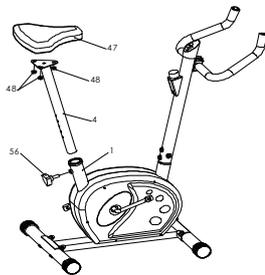
Krok 5: Upevněte sedátko (47) do sedadlové tyče (4) pomocí nylonové matice (48), poté vložte sedadlovou tyč do hlavní konstrukce (1), dotáhněte trohranným šroubem (56).
