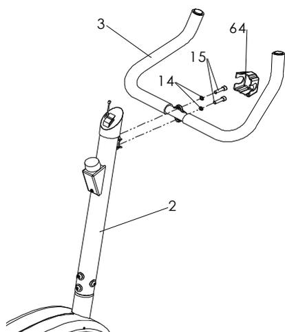
Krok 3: Upevněte řídítka (3) k úvodní části trubky (2) pomocí pérové podložky (14) a šestihranného šroubu s kulatou hlavou (15), poté instalujte svěrací kryt řídítek (64).
